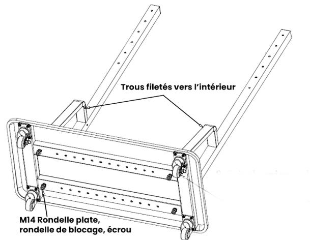
**Étape 3 :** Une fois les colonnes verticales en place, retirez la vis des trous de montage de l'étagère. Faites glisser l'étagère en position et fixez-la en place avec les vis. Vous pouvez maintenant serrer les écrous des colonnes installées à l'étape précédente.
