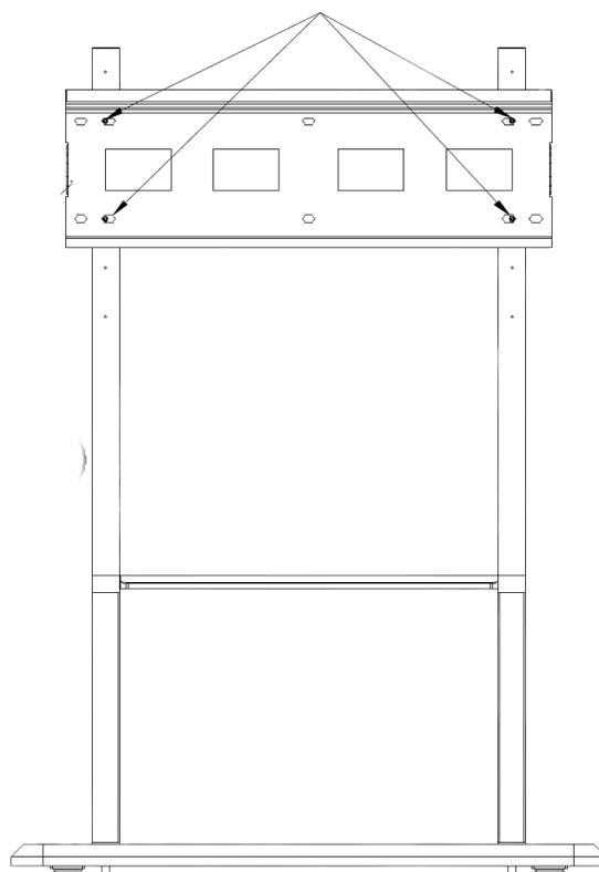
**Étape 6 :** Accrochez l'écran sur le chariot mobile. Utilisez les 2 vis de sécurité M5x100 mm préinstallées pour verrouiller l'écran au chariot mobile.
